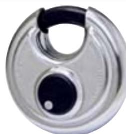
シリンダーの性能が高く・ホコリなどの異物侵入による動作不良を防ぐシリンダーカバー・施錠時にシャックル(吊)部を切断から防ぐシャックルガード仕様の南京錠です。
