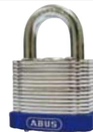
腐食に強いメッキを施した薄鉄板を積層したラミネート式南京錠です。シャックルには焼き入れ鉄、または特殊合金鋼(製品サイズにより異なる)を使用することで耐破断性をアップしています。
