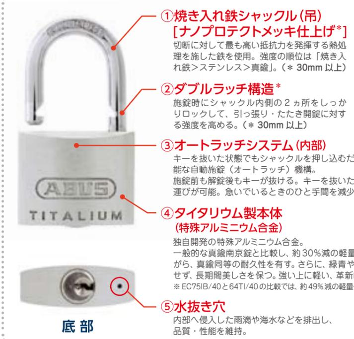
【ナノプロテクト (NANO PROTECT)】とは従来よりも細かい粒子を使った新技術のメッキ処理。表面をスキマなく覆い、外気・水分・チリ・傷・摩耗・腐食からシャックルを効果的にガード。
