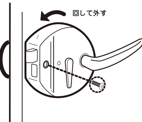
本体を回転させてツメを外し、抜きます。
