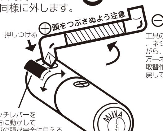
工具の先端をしっかりと奥まで挿入し、ネジの頭を潰さぬよう押しつけながら、ゆっくりと回して下さい。万ーネジの頭を潰してしまったら取替作業を中止して元の使用状態に戻して下さい。
