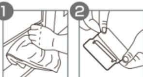
②両面テープを片面だけはがし、はいれーぬメイト裏側のサッシとの接着面に貼り付けます。また、レールの裏面には防犯ステッカーを室外側から見えるように貼ってください。
