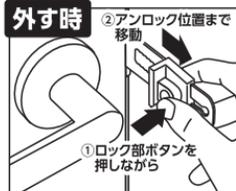
ロック部のボタンを押しながら後ろに引き、ドアを開く際に邪魔にならないようアンロック位置まで移動させます。製品が落下しないよう手で持ちながらドアを開け、取り外してください。
