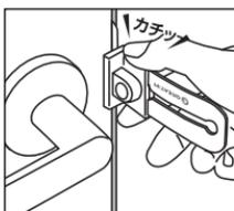
ドアにロック部が触れたらボタンから手を離し、「カチッ」とクリック音が鳴ったことを確認します。最後にドアが開かないことを確認し、設置完了です。
